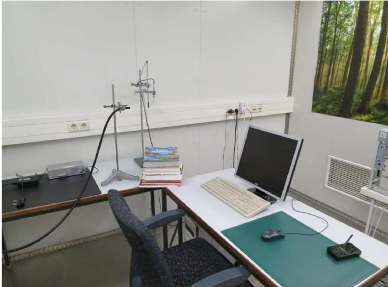
Sitzplatz des Probanden mit Ansaugschlauch für die Ultrafeinpartikelmessung, Sonden für das Klimamonitoring und Messgerät für Partikel im  $\mu\text{m}$ -Bereich (Grimm 1.108)
